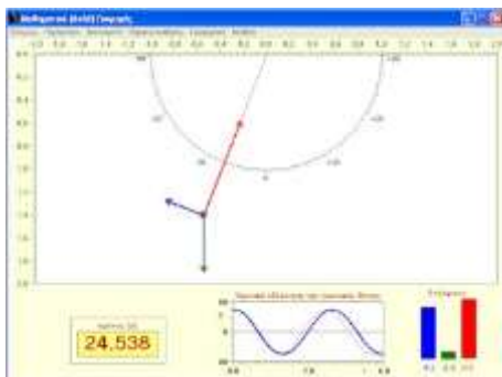
4. Μαθηματικό (απλό) εκκρεμές και γενίκευση σε κίνηση μέσα σε ομογενές πεδίο δυνάμεων Η μαθηματική έκφραση για τον ακριβή υπολογισμό της περιόδου του απλού εκκρεμούς.
