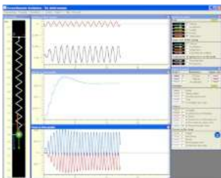
7. Εξαναγκασμένη αρμονική μηχανική ταλάντωση και συντονισμός Ένα σώμα κρέμεται από ένα ελατήριο του οποίου το άνω άκρο τίθεται σε απλή αρμονική ταλάντωση. Η κίνηση του σώματος είναι εξαναγκασμένη αρμονική ταλάντωση. Για να κατανοήσετε το φαινόμενο σας προσφέρουμε: 6 παρουσιάσεις, 13 προτεινόμενα παραδείγματα, δυνατότητα παρακολούθησης της χρονικής εξέλιξης 21 σχετικών φυσικών μεγεθών και 11 διανυσμάτων. Με ακινητοποίηση του άνω άκρου του ελατηρίου μπορείτε να συμπεριλάβετε στις συζητήσεις σας την ελεύθερη αμείωτη και την ελεύθερη φθίνουσα ταλάντωση. Δείτε το σώμα να κινείται με τρόπο διακριτότητας στην περίπτωση σχεδόν συντονισμού και μηδενικών τριβών. Μελετήστε το ρυθμό αύξησης της ενέργειας του συστήματος στην περίπτωση συντονισμού με ή χωρίς τριβές. Δείτε τη μαθηματική ανάλυση του φαινομένου σε PDF
